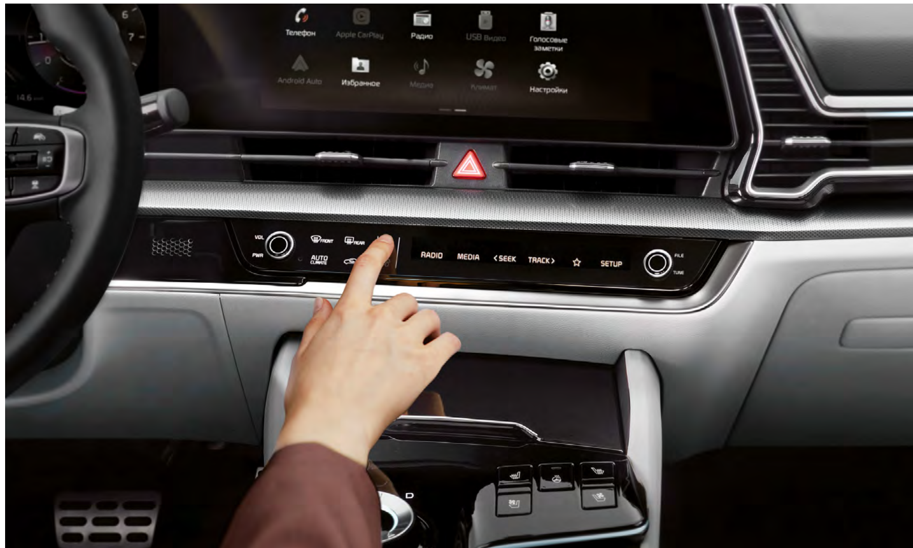
Переключаемый контроллер информационно-развлекательной системы / климат-контроля
